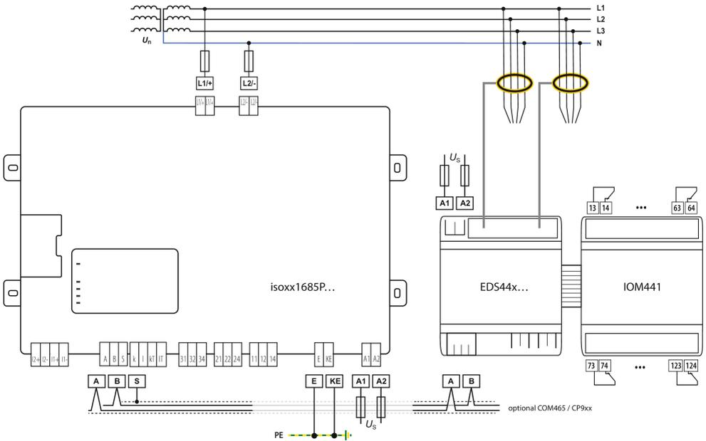
**i** Der Anschluss an das hier gezeigte 3NAC Netz dient als Beispiel zur Veranschaulichung der EDS-Komponenten. Der Anschluss an 3AC, AC und DC-Netze erfolgt wie im Anschlussbild dargestellt.
