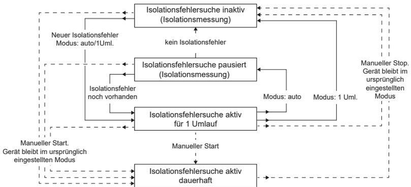
**i** Führen Sie während einer manuell gestarteten Isolationsfehlersuche keinen manuellen Test durch, da dadurch die Isolationsfehlersuche abgebrochen wird.
