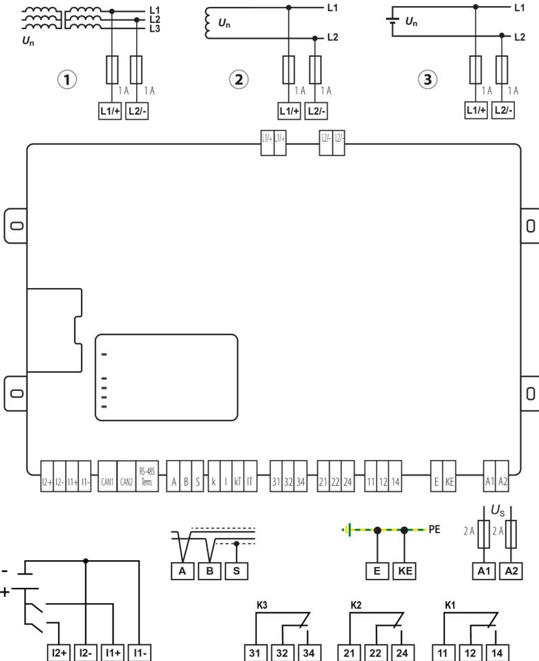
**1** [L1/+, L2/-]: Anschluss an ein 3(N)AC-Netz
