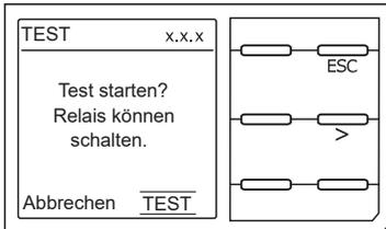
Während des Tests schalten alle Relais und die LEDs ALARM 1 und ALARM2 leuchten kurz.
