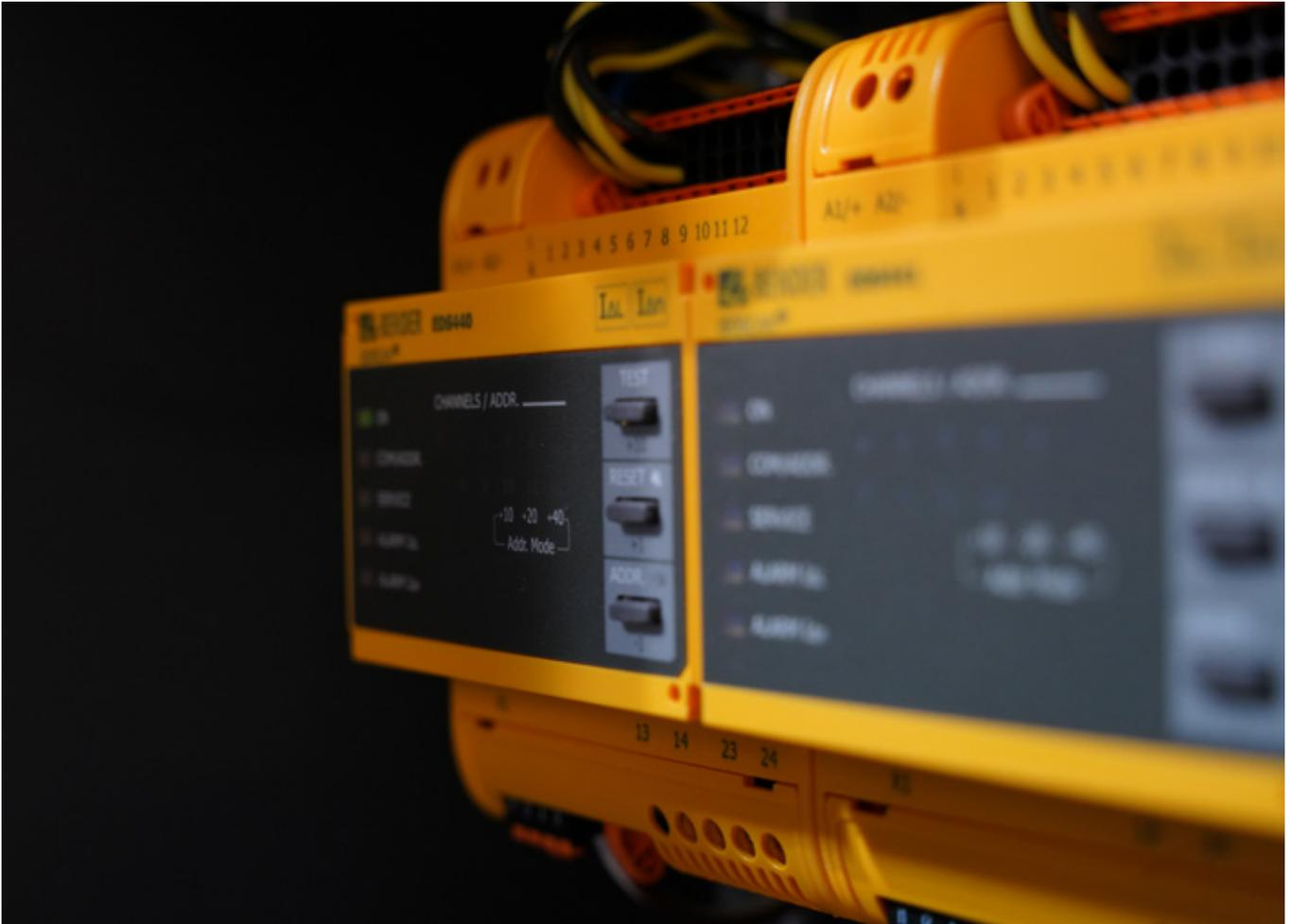
Bender-Lösungen ermöglichen einen einfachen Aufbau von komplexen und/oder gekoppelten Netzen durch die ISONet-Funktion zur Steuerung der Messberechtigung mehrerer iso685. Ein Hilfskontakt der Koppelschalter wird damit nicht mehr benötigt.
