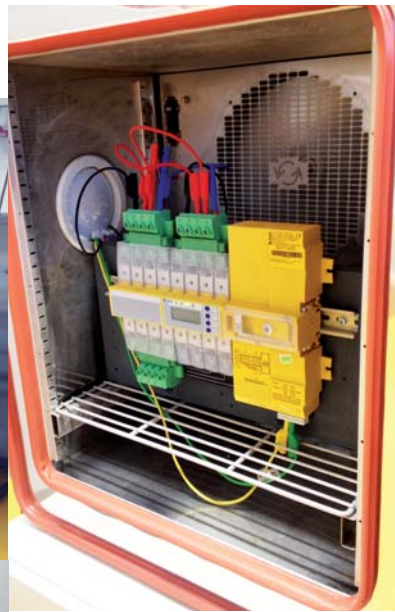
ATICS® im Test - Temperaturprüfung -25°C
