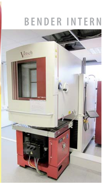
Klimaprüfkammer in Kombination mit Vibration
