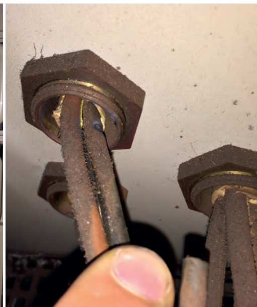
An dieser Stelle lag die Phase am Gehäuse auf und bedingte den Isolationsfehler
