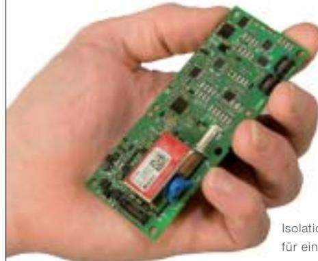
Isolationsüberwachungsgerät für ein E-Fahrzeug.
