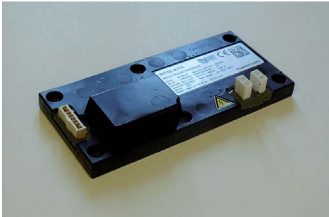
BILD 7: BEISPIEL FÜR EIN ISOLATIONSÜBERWACHUNGSGERÄT (A-ISOMETER®) AUS DEM E-MOBILITY BEREICH [WERKSFOTO, BENDER GRÜNBERG]
