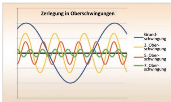
Abb. 3: Zerlegung des dargestellten Signals in die harmonischen Anteile (bis zur 7. Oberschwingung)
